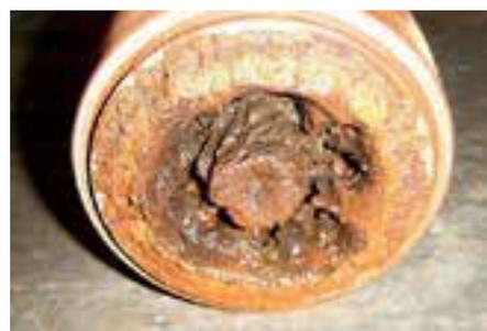
Dépôt d'ocre sur le rotor d'une pompe immergée
